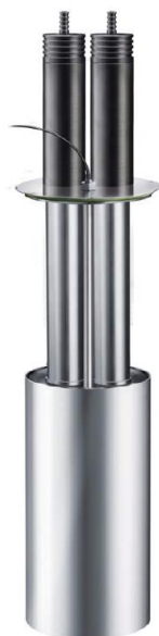
Rys. 18 Blok mikrokalorymetryczny urządzenia TAM III używany podczas pomiarów kiełkowania i wzrostu nasion fasoli Mung i słonecznika [118].
