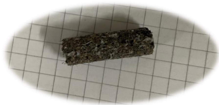
Rys. 88. Pelet o średnicy 8mm zawierający 50% peletu z łuski słonecznika oraz 50% peletu RDF
