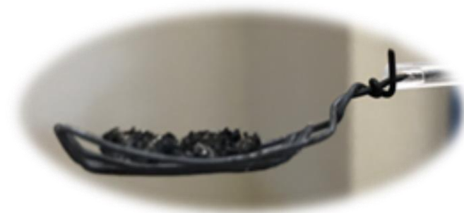
Rys. 40. Pozostałość po spaleniu peletu ze słomy w temperaturze 850°C przy G_s=2,5 \text{ kg/m}^2\text{s}
