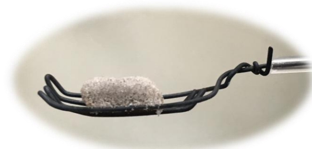
Rys. 39. Pozostałość po spaleniu peletu z łuski słonecznika w temperaturze 850°C przy G_s=2,5 \text{ kg/m}^2\text{s}
