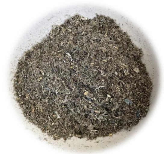
Rys. 86. Pelety po zmieleniu, mieszanka zawierająca 50% peletu z łuski słonecznika oraz 50% peletu RDF
