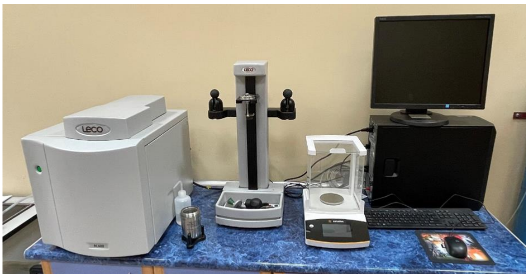
Rys. 6. Półautomatyczny kalorymetr LECO AC600
