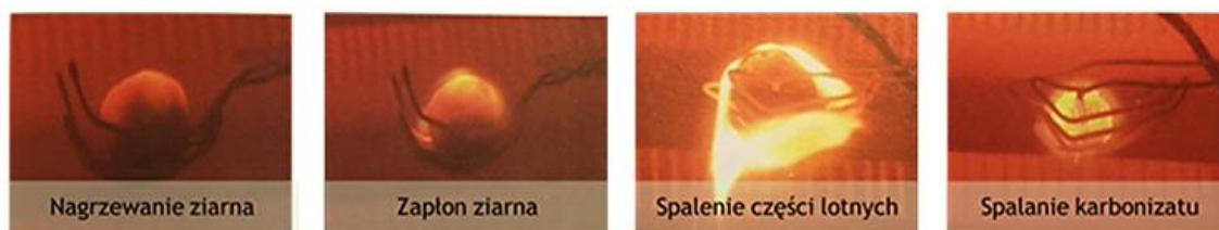
Rys. 61. Etapy spalania pojedynczego ziarna węgla w dwufazowym przepływie materiału inertnego modelującego warunki warstwy fluidalnej [106]
