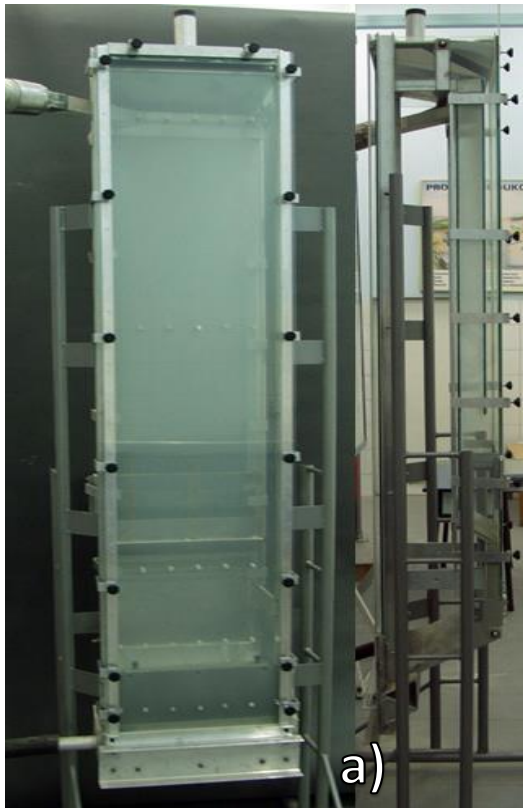
Rys. 23. Kolumna fluidyzacyjna: a) widok od przodu, b) widok z boku
