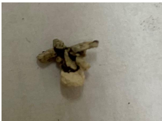
Rys. 72. Przykład spieku wytworzonego w reaktorze - eksperymencie 9 (średnica około 6 mm), które spowodowały defluidyzację złoża oraz problemy z pracą podajnika
