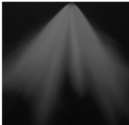
Rys. 4.4. Przykładowy obraz (pojedyncza klatka) wypływu paliwa z wtryskiwacza zarejestrowany za pomocą szybkiej kamery cyfrowej
