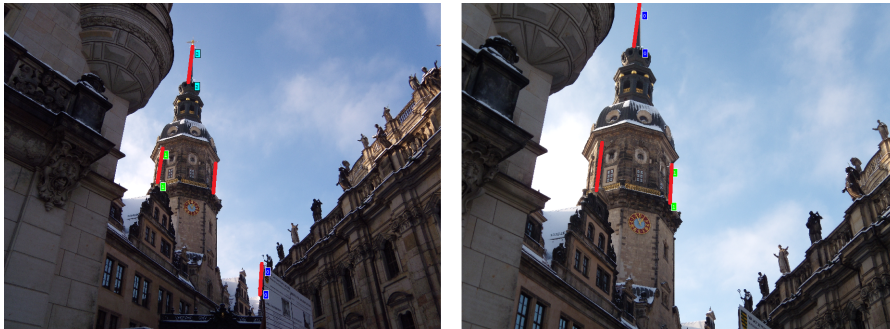
Rysunek 4.2: Dystorsja na podstawie zdjęć tego samego kadru z różnych urządzeń (przykładowe linie obarczone dystorsją oznaczono kolorem czerwonym). Zdjęcie po lewej: Nikon CoolPix S710 (2), parametr dystorsji k = -0,10323 ; zdjęcie po prawej: Nikon CoolPix S710 (1), parametr dystorsji k = -0,01799
