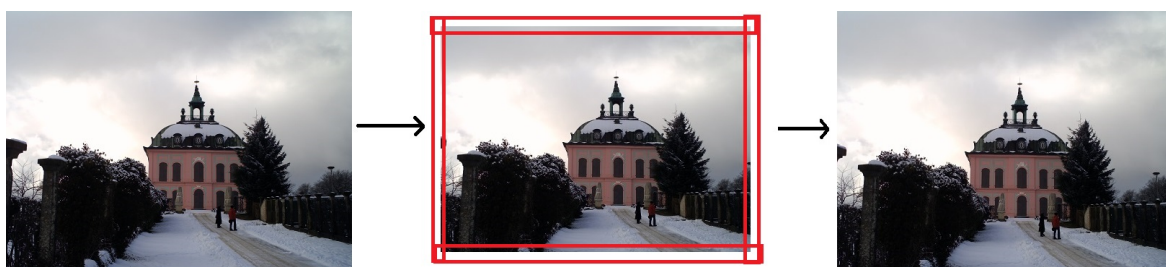
Rysunek 6.11: Po lewej: oryginalne zdjęcie I o wymiarach 2592 \times 1944 pikseli, w środku: zdjęcie I' przycięte łącznie o 20 pikseli (5 pikseli wzdłuż każdej krawędzi), po prawej: zdjęcie I' kadrowane i rozszerzone do oryginalnego rozmiaru. Aparat: Agfa Sensor 505
