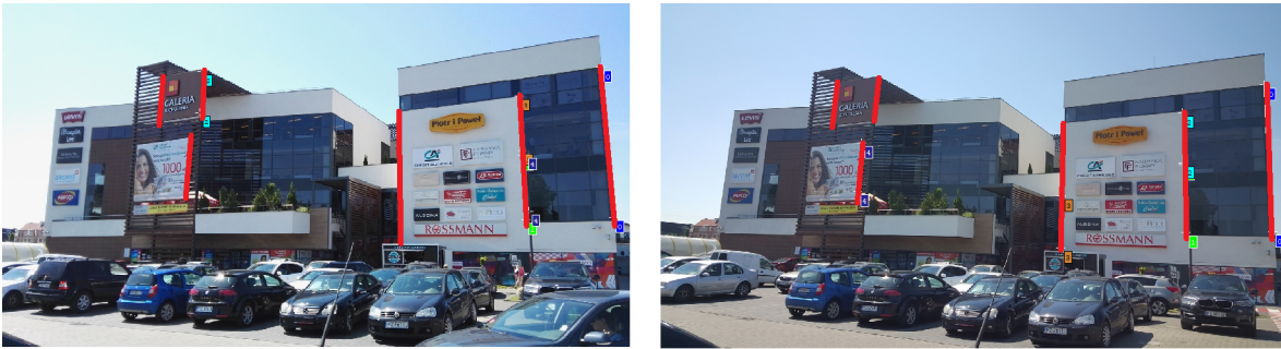
Rysunek 4.1: Dystorsja na podstawie zdjęć tego samego kadru z różnych urządzeń (przykładowe linie obarczone dystorsją oznaczono kolorem czerwonym). Zdjęcie po lewej: Huawei P8, parametr dystorsji k = -0,6782 ; zdjęcie po prawej: Samsung Galaxy S6, parametr dystorsji k = -0,2
