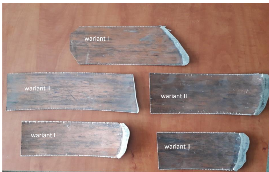
Rys. 55. Widok kompozytowych pasm po ostatnim zrealizowanym przepuście walcowniczym zrealizowanym dla gniotu całkowitego \epsilon=89,2\% prowadzonych dla walcowanych wg wariantów I i II
