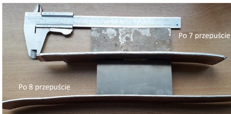
Rys. 53. Widok przewalcowanych próbek po 7 przepuście dla a_{vopt}=0,83 , oraz po 8 przepuście dla a_{vopt}=0,92
