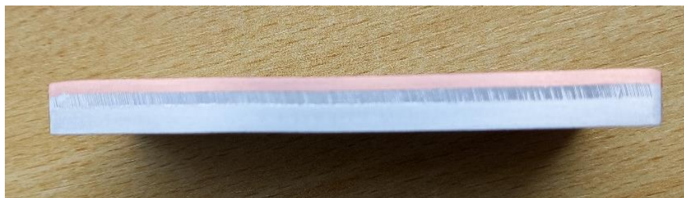
Rys. 28. Widok kompozytu warstwowego po połączeniu metodą zgrzewania wybuchowego
