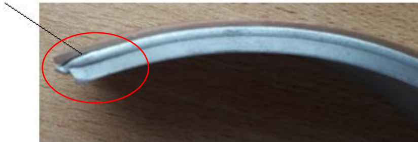
Rys. 46. Wyraźne powstawanie rozwarstwienia materiału próbki walcowanej dla gniotu względnego \varepsilon=15\% - wariant II
