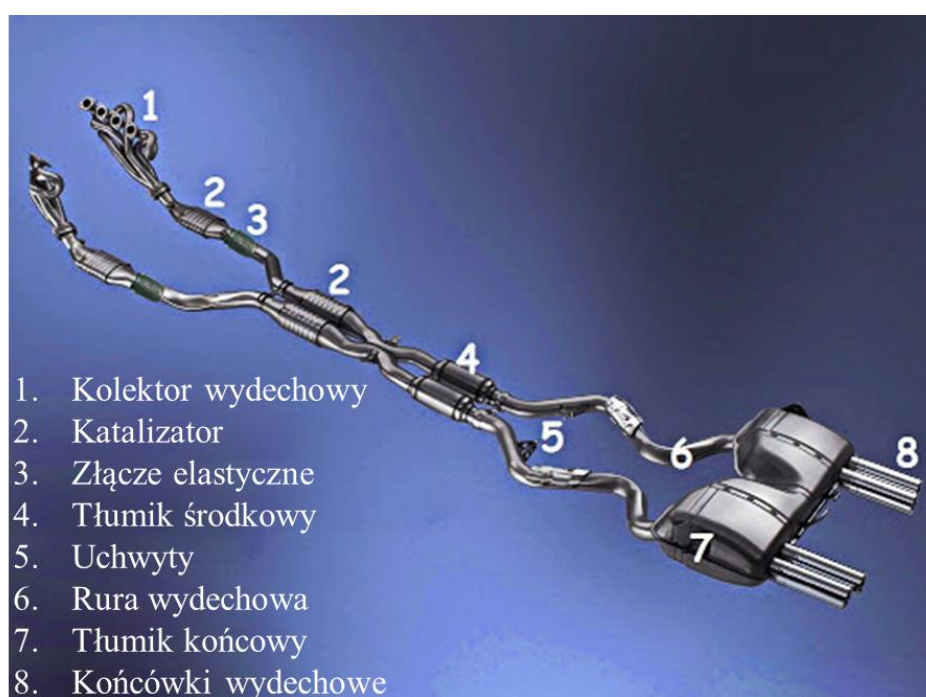
Rys. 6. Schemat budowy samochodowego układu wydechowego [30]
