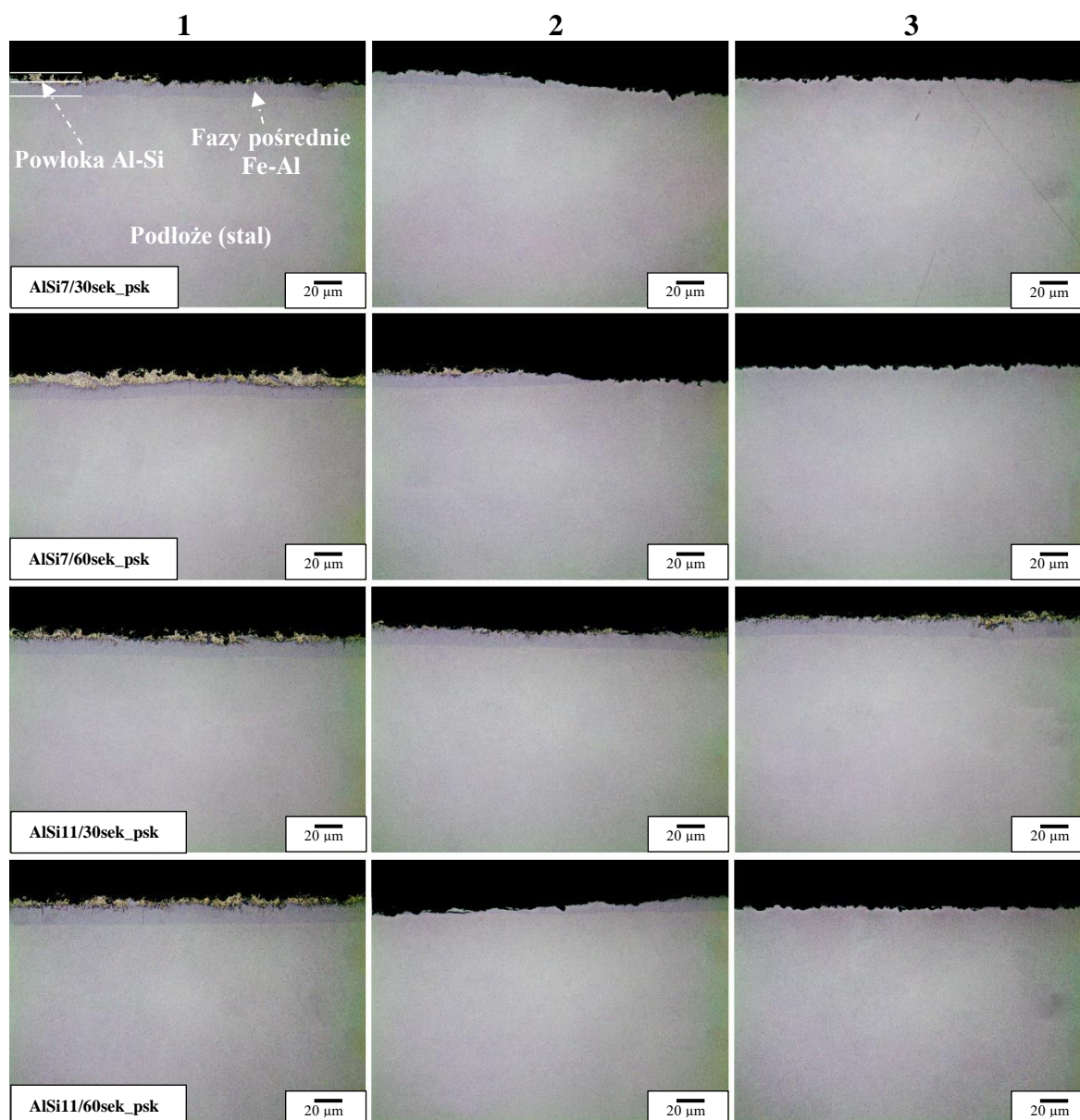
Rys. 176. Przekroje poprzeczne powłok zanurzeniowych na podłożach piaskowanych po uderzeniach mechanicznych w czasie 90s
