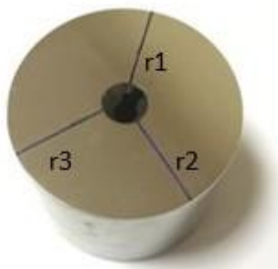
Rys. 31. Próbka z oznaczonymi promieniami, wzdłuż których realizowano pomiar twardości
