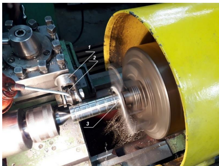
Rys. 17. Nagniatąk krążkowy NK-01 (1) z możliwością stosowania wymiennych elementów w postaci krążka (2) przeznaczony do nagniatania statycznego naporowego tocznego (NSNT) powierzchni walcowych zewnętrznych (3)
