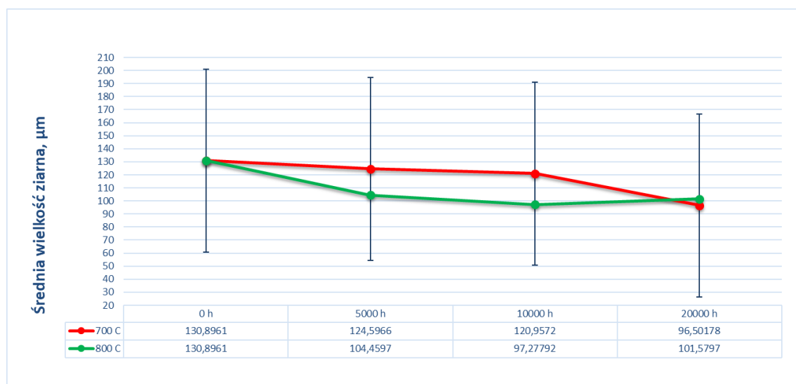
Rys. 83. Zmiana średniej średnicy ziarna w stopie HR6W w stanie dostawy i po starzeniu w temperaturze: a) 700°C, b) 800°C
