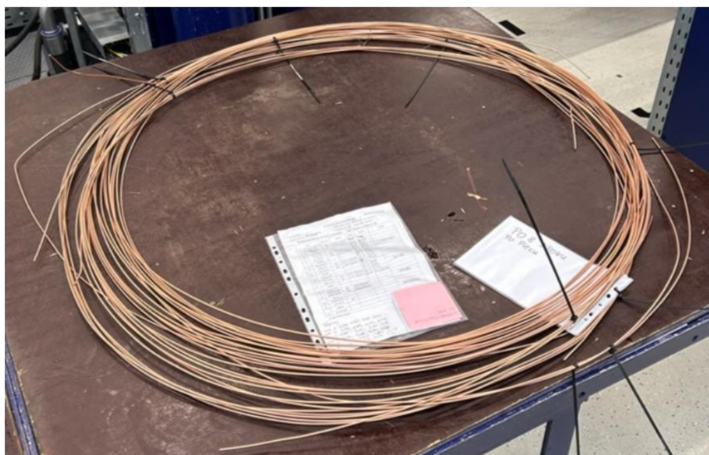
Rysunek 39. Materiał do ciągnięcia, średnica: 2,86\text{ mm} ; grubość ścianki: 0,215\text{ mm}
