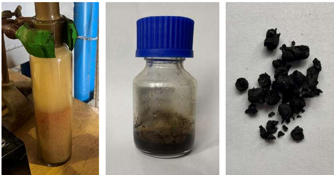
Rys. 7. Produkty pirolizy: a) gaz pirolityczny przechodzący przez osuszacz, b) kondensat, c) karbonizat.
