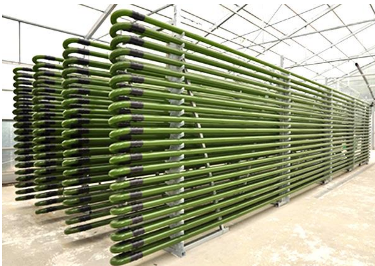
Rys.4. System fotobioreaktorów rurowych w pomieszczeniu z przezroczystych materiałów [139]
