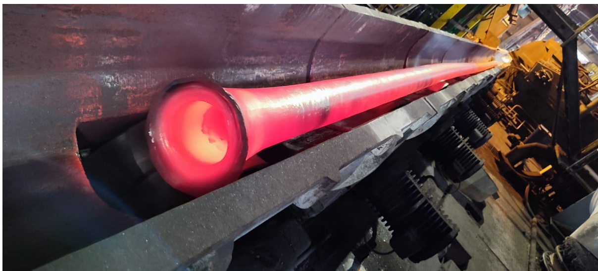
Rysunek 44. Widok rury z kielichem bezpośrednio po zakończeniu procesu wydłużania
