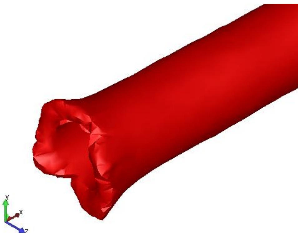
Rysunek 62. Rura surowa z kielichem otrzymana w wyniku symulacji numerycznych metodą walcowania pielgrzymowego
