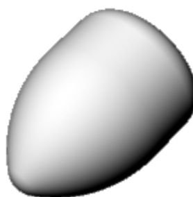
Rysunek 50. Model przestrzenny główki dziurującej skośnej walcarki wydłużającej
