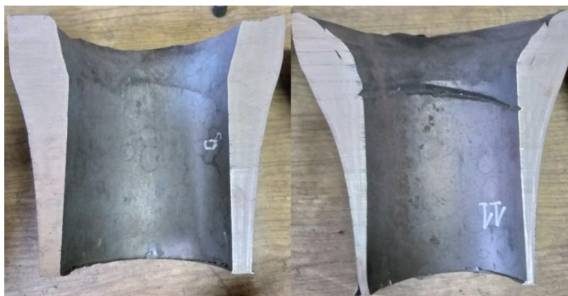
Rysunek 32. Przykłady kielichów jako odpad technologiczny
