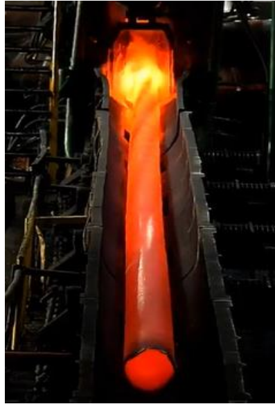
Rysunek 33. Rura w procesie walcowania na walcarce pielgrzymowej
