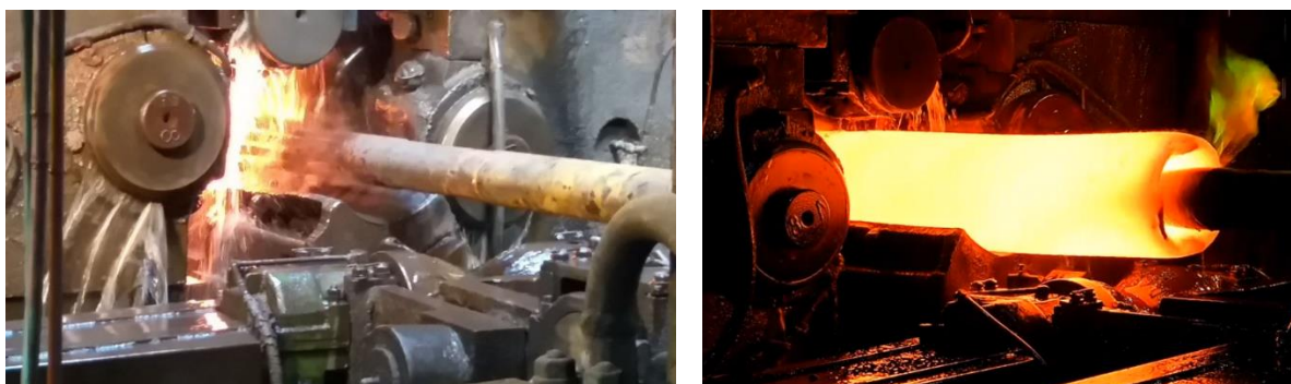
Rysunek 16. Widok walcarki skośnej wydłużającej w początkowym i końcowym etapie walcowania
