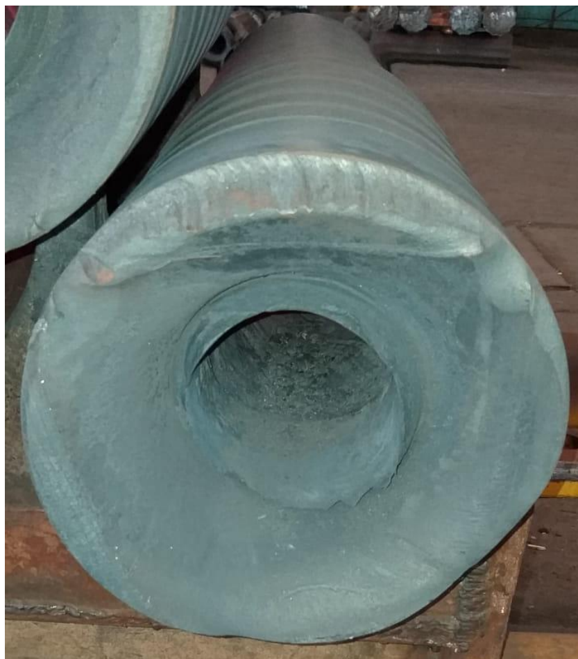
Rysunek 41. Przykład tulei grubościennnej z wyrwanym denkiem
