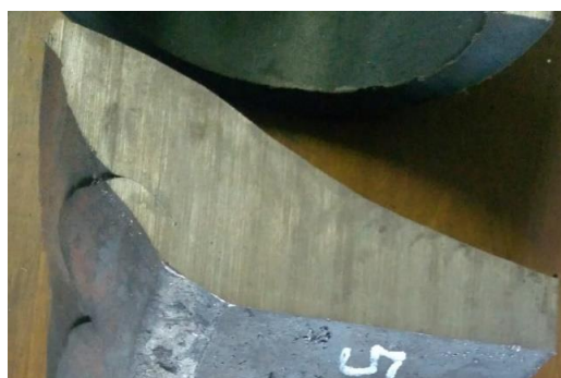
Rysunek 80. Fragment przekroju kielicha powstających po walcowaniu pielgrzymowym przy położeniu p_4 główki dziurującej alongatora, kątach rozwalcowania \alpha = 4^\circ i zukosowania \beta = 3^\circ
