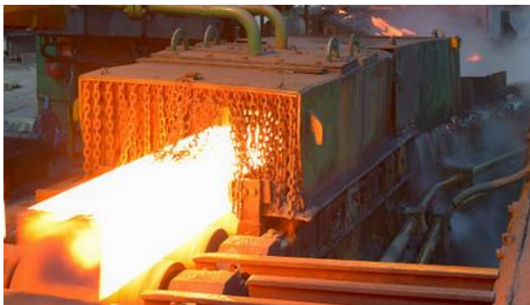
Rysunek 27. Usuwanie zgorzeliny w zbijaczu hydraulicznym
