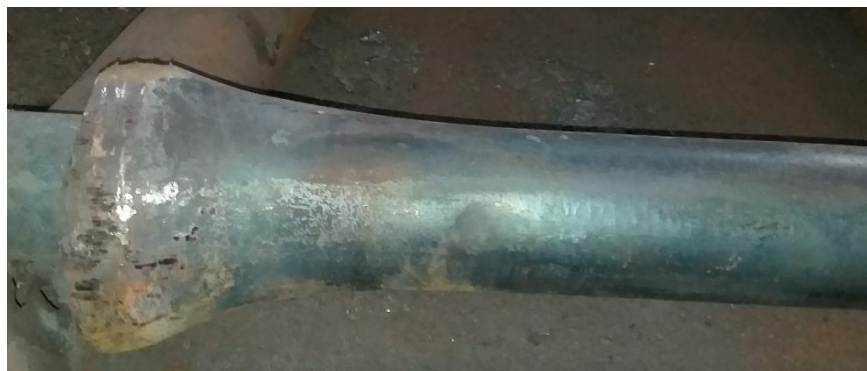
Rysunek 31. Rura z odpadem technologicznym tzw. kielich
