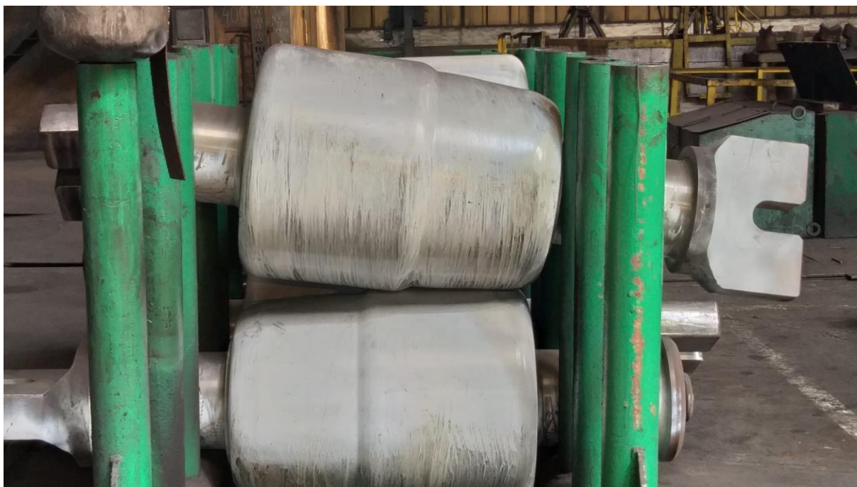
Rysunek 39. Walce alongatora w zakładzie przemysłowym
