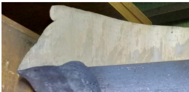
Rysunek 79. Fragment przekroju kielicha powstających po walcowaniu pielgrzymowym przy położeniu p_0 główki dziurującej alongatora, kątach rozwalcowania \alpha = 3^\circ i zukosowania \beta = 6^\circ
