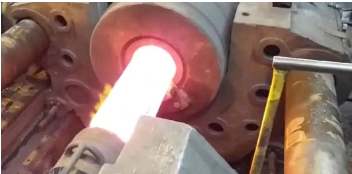
Rysunek 37. Przykład tulei grubościennnej w momencie wyciągania z prasy
