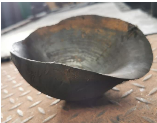
Rysunek 40. Przykład wyrwanego denka
