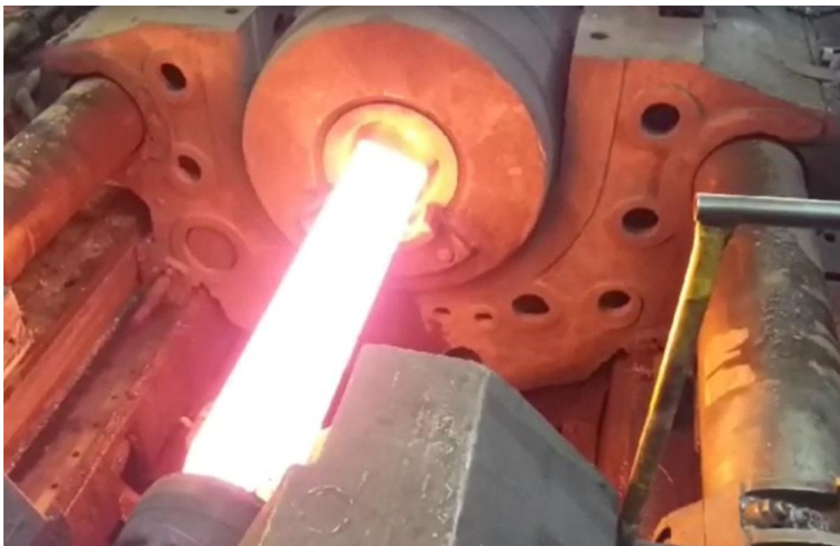
Rysunek 36. Wlewek przygotowany do wprowadzenia do matrycy prasy
