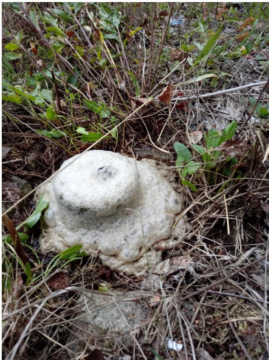
Rysunek 25. Gwałtowna reakcja po aplikacji roztworów utleniających
