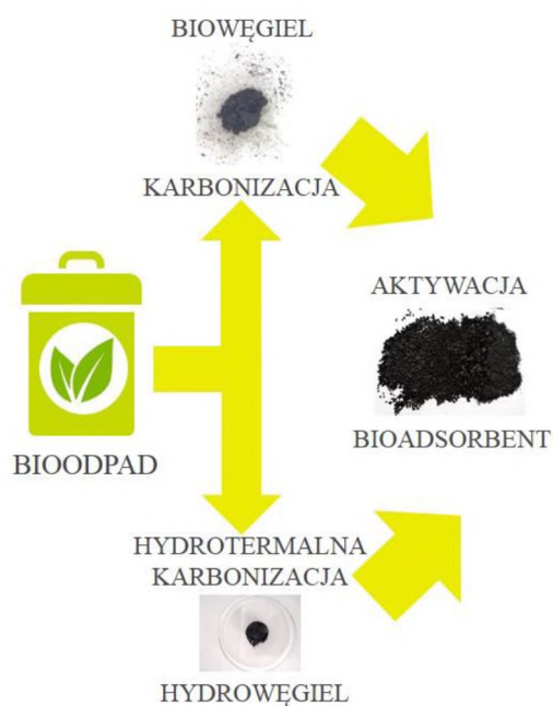
Rysunek 3. Schemat przedstawiający produkcję bioadsorbentu z bioodpadu
