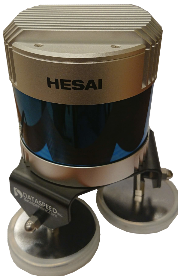
Rys. 6.9. Lidar Hesai Pandr64.
