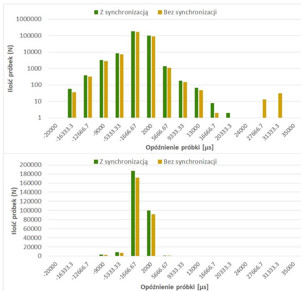
Rys. 6.4. Histogram uzyskanych opóźnień [ \mu\text{s} ] rzeczywistego czasu przybycia ramki względem idealnego dla kamery w pierwszym eksperymencie.
