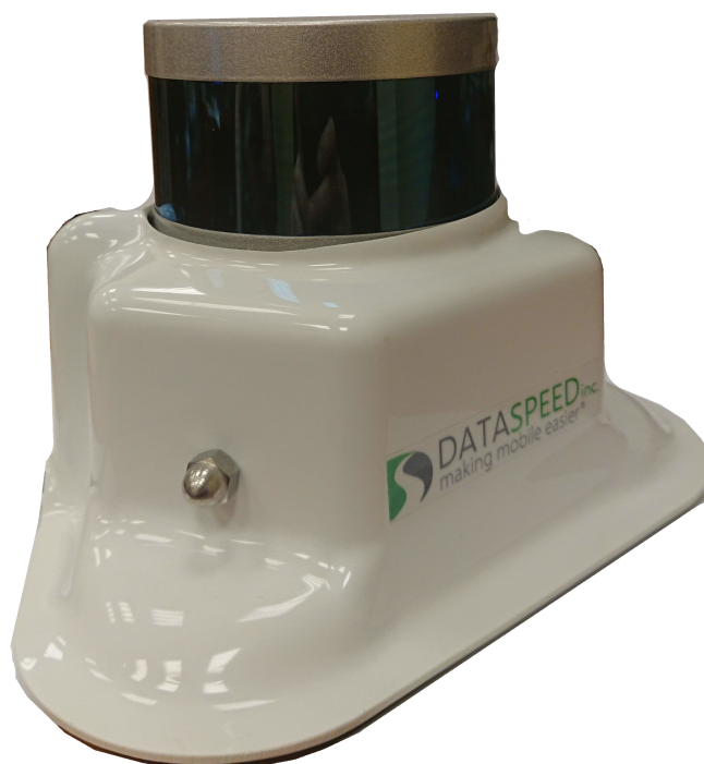
Rys. 6.8. Lidar Velodyne Puck Hi-Res.
