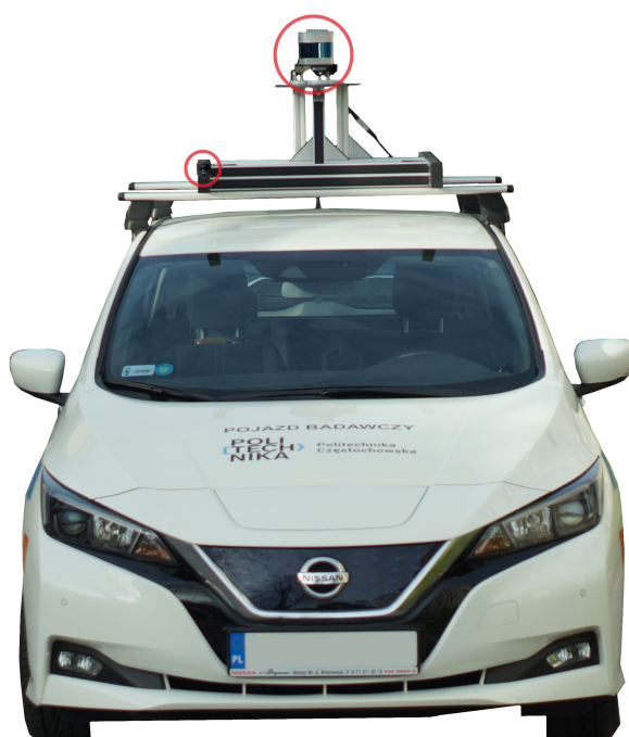
Rys. 4.1. Pojazd badawczy z oznaczonym umiejscowieniem LiDAR-u oraz kamery.
