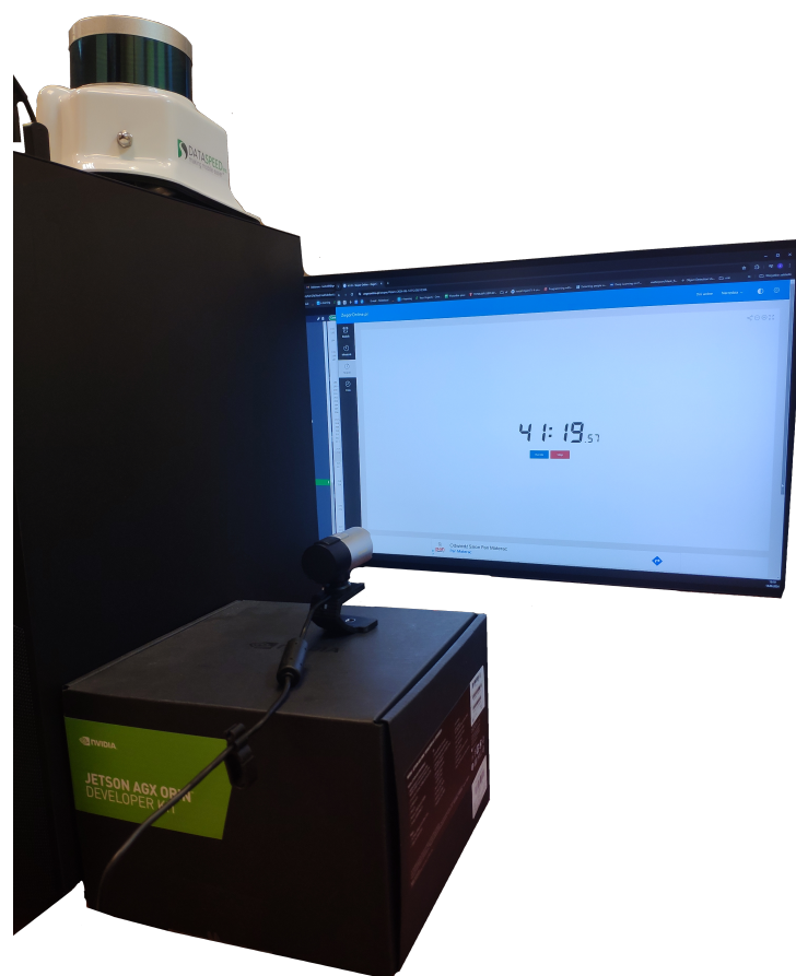
Rys. 6.2. Przygotowane stanowisko z LiDAR-em oraz kamerą dla drugiego eksperymentu systemu synchronizowanej akwizycji danych.
