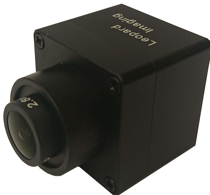
Rys. 6.12. Kamera Leopard Imaging LI-IMX390-GMSL2-120H.
