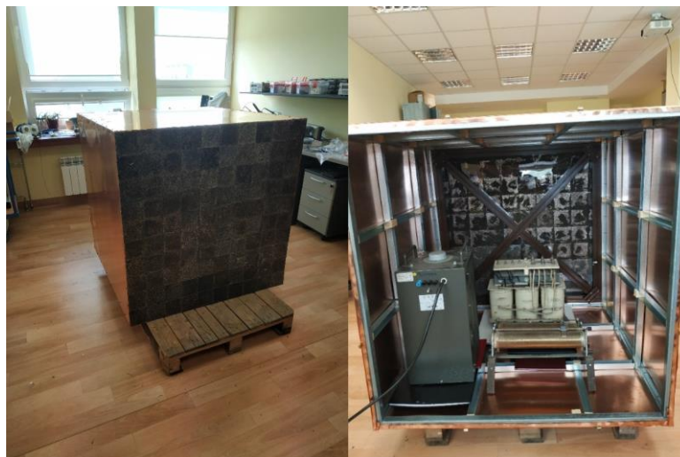
7.44. Zdjęcie komory do badania prądu stałego DC
