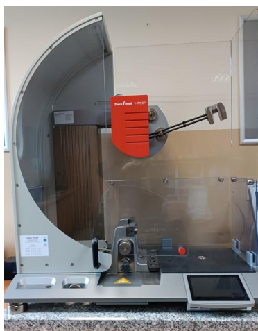
Rys. 7.37. Zdjęcie młota do pomiaru udarności Zwick Roel HIT5.5P
