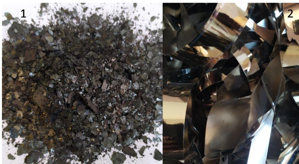
Rys.7.3. Nieprzetworzone materiały 1 - zendra, 2 – blacha nanokrystaliczna
