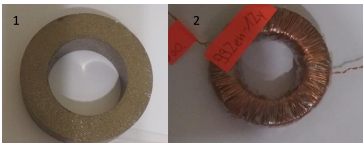
Rys. 7.11. Próbki do badań przenikalności magnetycznej zastosowano wyselekcjonowane kompozyty o zawartości 1 - kompozyt NK 99% żywica z fenolowo-arylową 1%, 2 – zendra 99% żywica z fenolowo-arylową 1%
