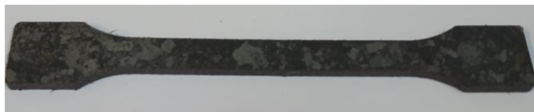
Rys. 3.2. Widok próbki do statycznego rozciągania wykonanej z napełniaczem z zendry 70% i HDPE 30%, zgodnie z normą ISO 527-2
