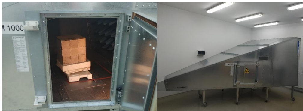
Rys. 7.41. Zdjęcie małej komory w komorze bez odbiciowej wraz z odbiornikiem do częstotliwości 2,7 GHz
