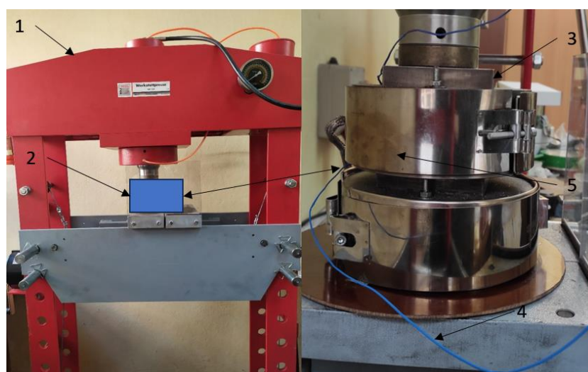
Rys. 7.6. Schemat stanowiska do wytwarzania próbek 1 - prasa hydrauliczna, 2 - tłok i stół prasy, 3 - forma prasownicza, 4 - sonda pomiaru temperatury, 5 – grzałka
