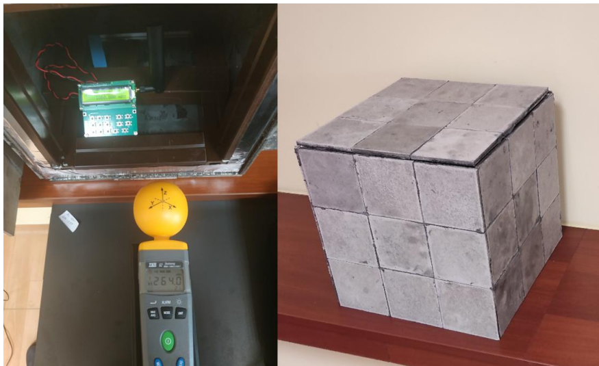
Rys. 7.40. Zdjęcie małej komory przed włożeniem do komory bez odbiciowej wraz z odbiornikiem do częstotliwości 2,7 GHz
