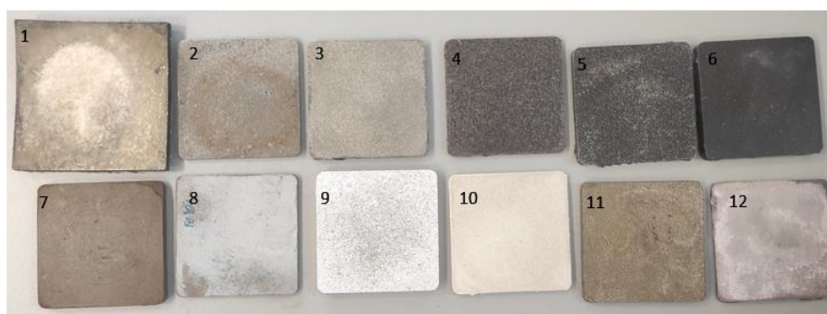
Rys. 7.2. Wypraski kompozytowe wytworzone do badań wstępnych. 1 - POM z zendrą i nanokrystalikiem, 2 - PVC z żelazem i nanokrystalikiem, 3 - PVC z nanokrystalikiem, 4 - PVC z pyłem złomowiskowym, 5 - PVC z zendrą, 6 - HDPE z zendrą, 7 - PVC z pyłem z złomowiskowym włóknistym, 8 - PVC z żelazem, 9 - PVC z aluminium, 10 - HDPE z ceramiką, 11 - PVC z mosiądzem, 12 - POM z zendra i ceramiką
