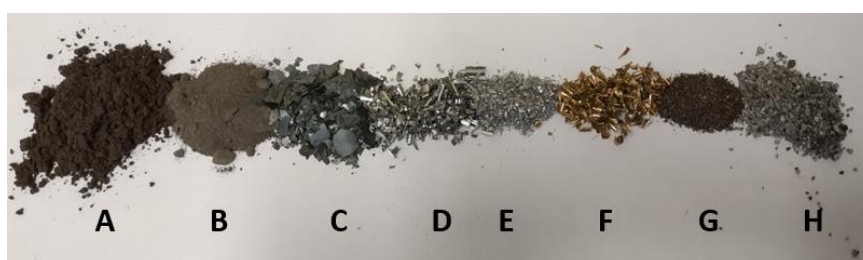
Rys. 7.1. Selekcjonowane materiały do badań wstępnych A) Pył złomowiskowy włóknisty, B) Pył złomowiskowy, C) zendra, D) wióry aluminium, E) nanokrystalik, F) wióry mosiężne, G) rozdrobnione kable miedziane, H) amorfik
