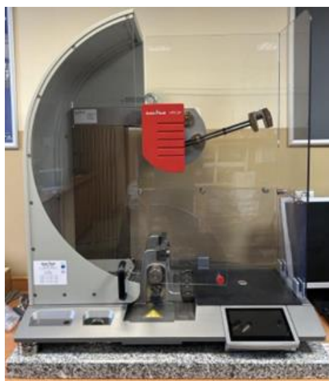
Rys. 3.10. Młot Charpiego Zwick/Roell HIT 5.5P do badania udarności próbek z tworzyw sztucznych z karbem lub bez karbu
