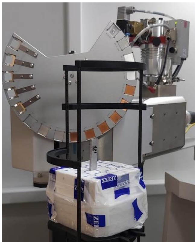
Rys. 3.7. Mocowanie próbki do badań na tomografie ZEISS Metrotom 1500
