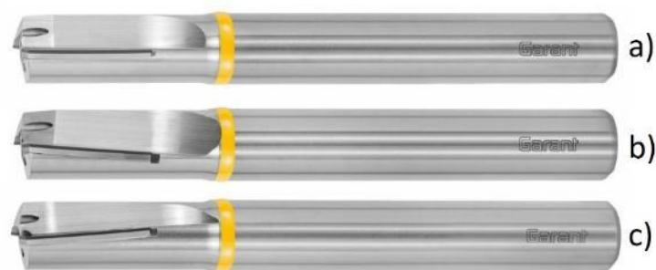
Rys. 1.9. Wysokowydajne frezy PKD a) kąt osiowy 0^\circ b) dodatni kąt osiowy 2^\circ lub 4^\circ c) ujemny kąt osiowy -2^\circ lub -4^\circ [35]
