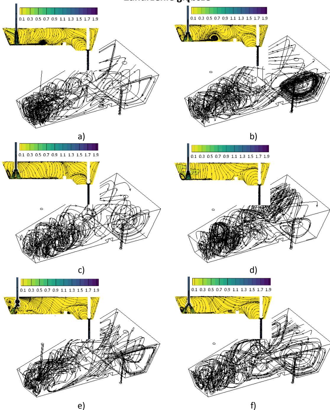
Rys.59. Pola przepływu ciekłej stali w warunkach nieizotermicznych przez całą objętość kadzi pośredniej oraz płaszczyznę symetrii dla 1-wylewowej kadzi pośredniej dla głębszego zanurzenia wylewu osłonowego w ciekłej stali: a) wariant bazowy, b) wariant 1, c) wariant 2, d) wariant 3, e) wariant 4, f) wariant 5
