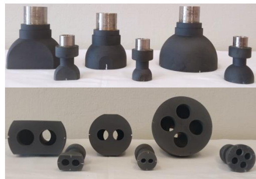
Rys.47. Modele wylewów osłonowych w skali 0,4 i 0,16
