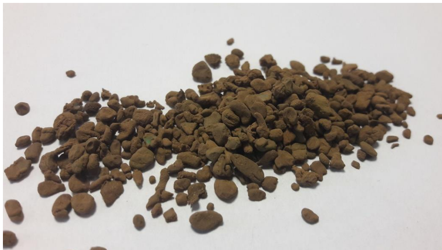
Rysunek 34. Kruszywo CLA (PET+ssFA) wytworzone metodą A
