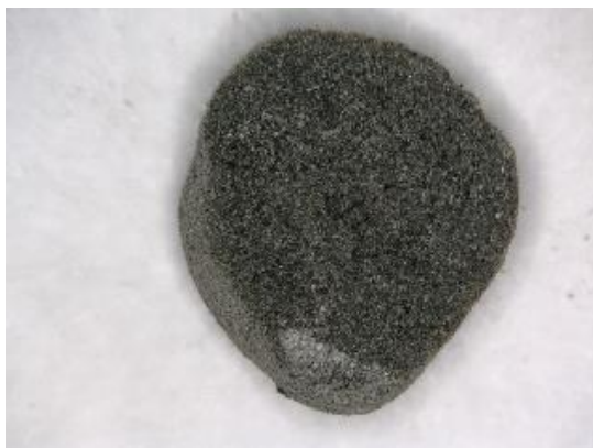
Rysunek 66. Widok przekroju ziarna z mikroskopu optycznego x40 - seria B4M
