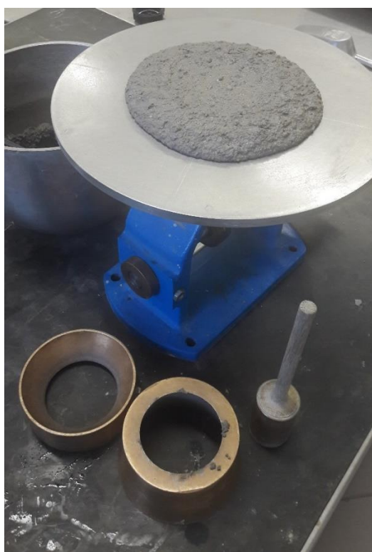
Rysunek 39. Stolik rozptywy do badania zapraw zgodnie z norma PN-EN 1015-3
