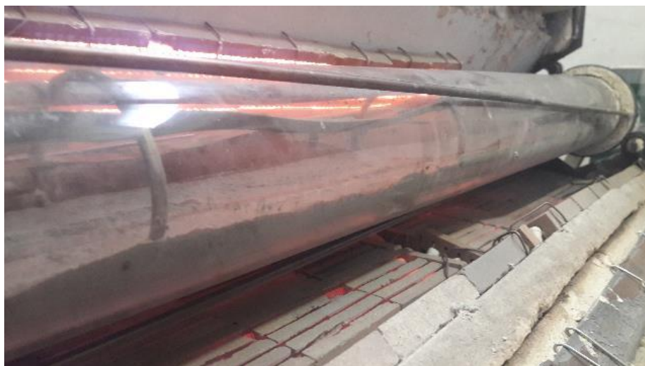
Rysunek 56. Widok obrotowego pieca szklanego z fragmentem obudowy oraz grzałkami i czujnikami temperatury
