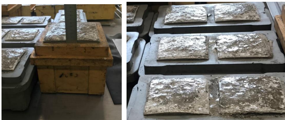
Rysunek. 126. Widok na próbki dojrzewającego betonu wykazujące ślady zmiany objętości betonu (ekspansję)
