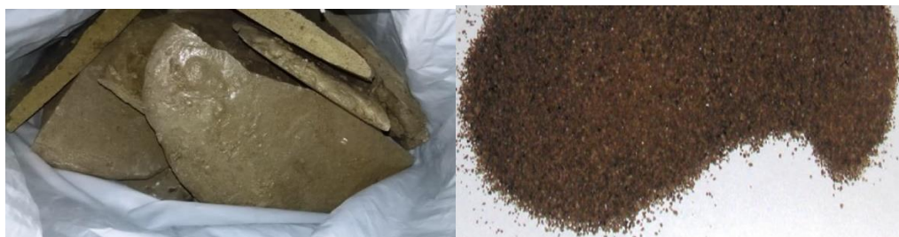
Rysunek 15. Kruszywo z PET i piasku wytworzone w ekstruderze i rozkruszone (Gouasmi i in.2019)
