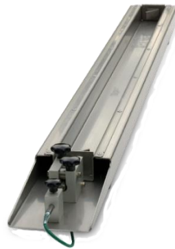
Rysunek 89. Rynna do badania zjawisk skurczowych kompozytów cementowych. ( http://www.schleibinger.com )
