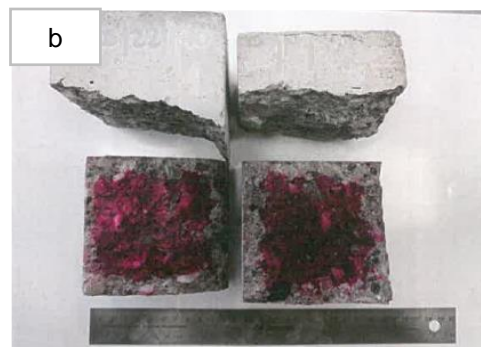
Rysunek 142. Widok próbek betonu M3 przed rozpoczęciem badania (a) i po 70 dniach badania odporności na karbonatyzację (b)
