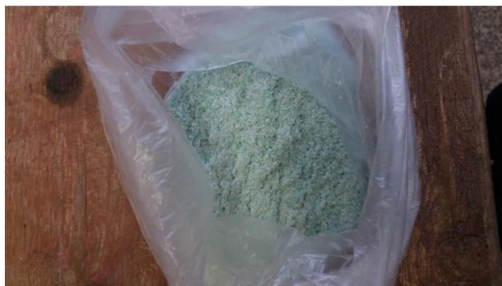
Rysunek 14. Frakcja drobna odpadowego PET uzyskana w młynku nożowym (Figueiredo i in., 2022)
