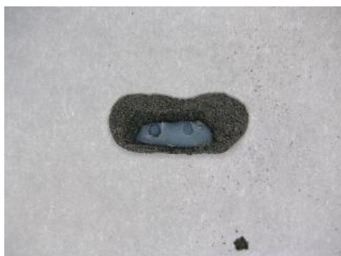
Rysunek 60. Przykładowy przekrój ziarna kruszywa wytworzonego w T_e = T_1 – seria B1M
