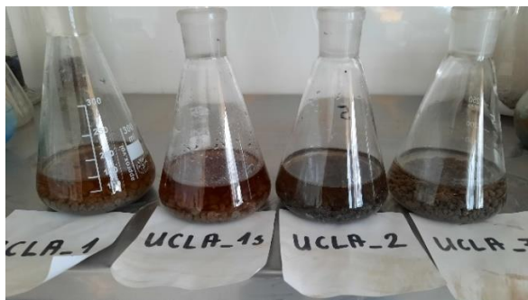
Rysunek 123. Widok próbek kruszywa zalanych roztworem 0,316 M NaOH – stan po 14 miesiącach 2
