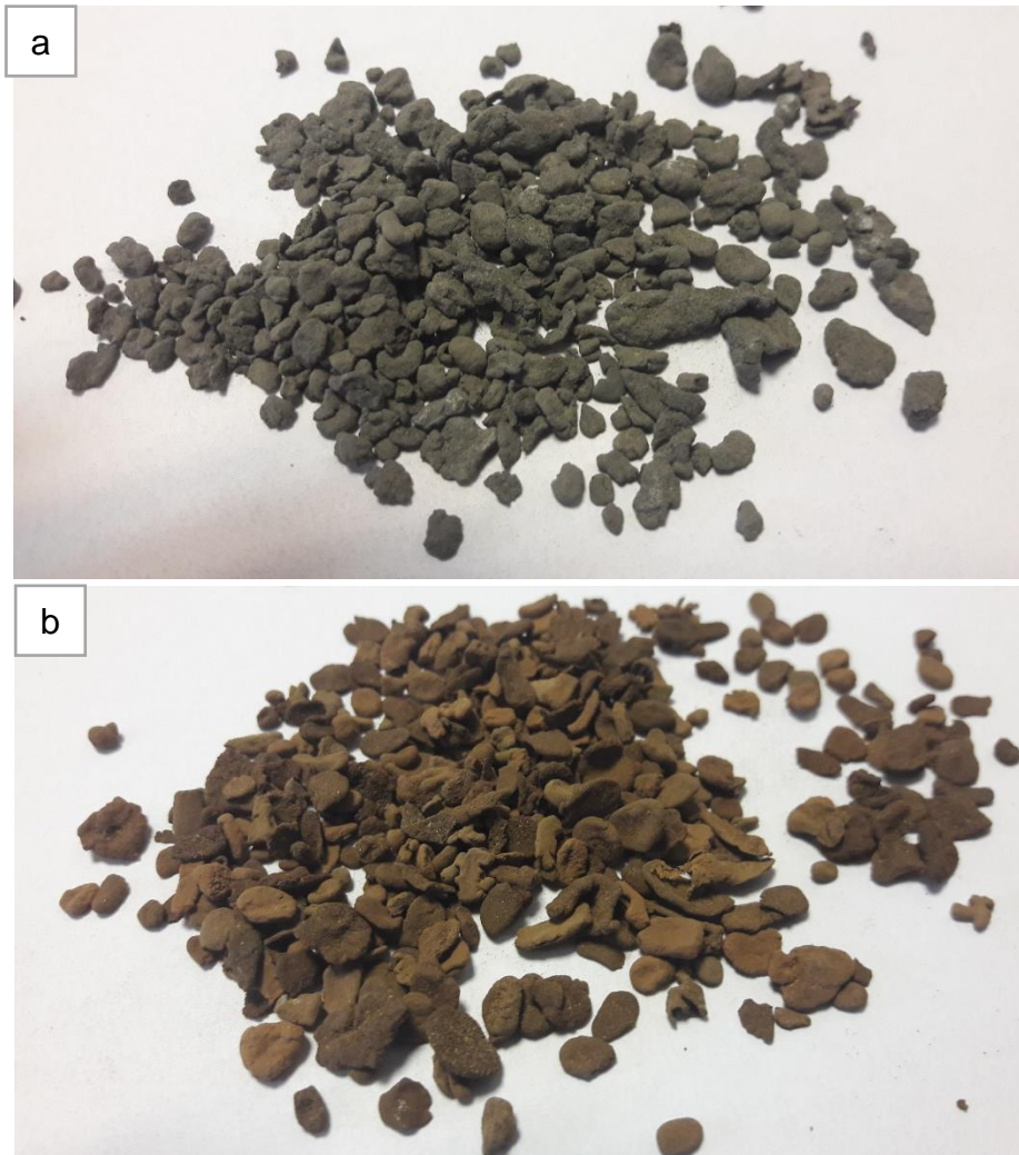
Rysunek 36. a/ Kruszywo CLA_1 (PET+FA) wytworzone metodą B, b/ Kruszywo CLA (PET+ssFA) wytworzone metodą B
