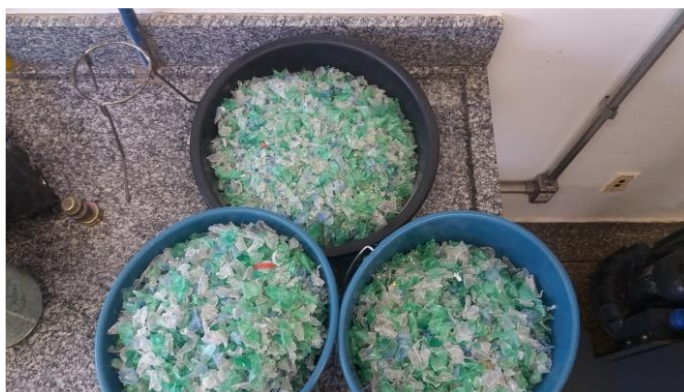
Rysunek 13. Różne granulacje płatków z odpadowego PET stosowanych do badań (Figueiredo i in., 2022)
