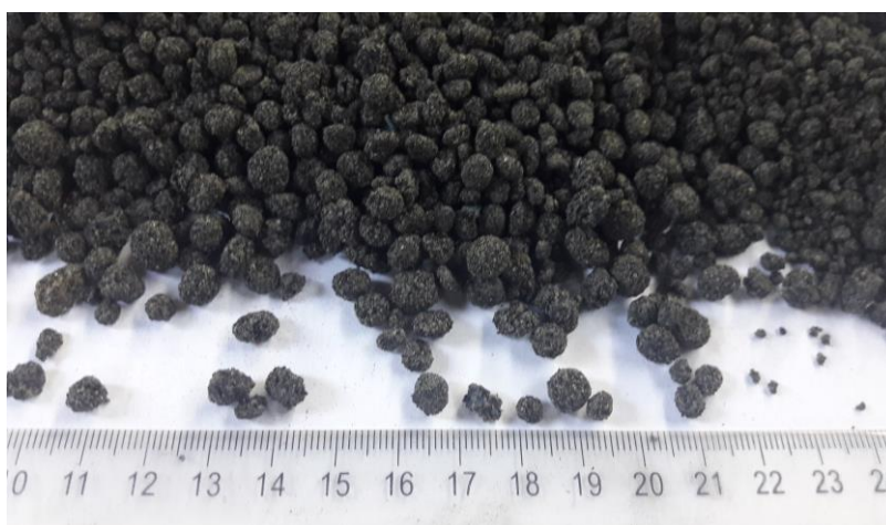
Rysunek 73. Kruszywo UCLA_MPŻ utworzone przez połączenie PET i mieszanki popiołowo-żużlowej (MPŻ)
