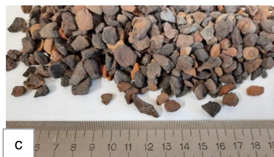
Rysunek 85. Kruszywa dostępne na rynku wykorzystane w projekcie a/ żwir naturalny 2- 8 mm, b/ keramzyt Liapor 4-8 mm, c/ popiołoporyt Certyd 4-8 mm.
