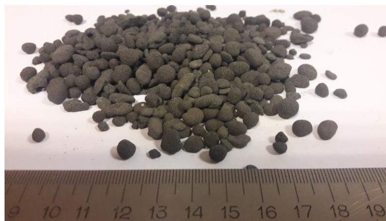
Rysunek 71. Kruszywo UCLA_FA wytworzone przez połączenie PET i popiołu lotnego krzemionkowego (FA)
