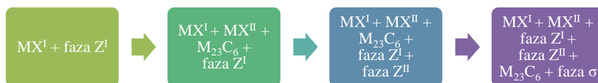
Rys. 96. Sekwencja procesu wydzieleniowego w stali HR3C
