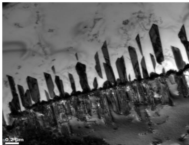
Rys. 53. Lamelarny układ wydzieleni węglików M_{23}C_6 w stali HR3C starzonej przez 500 godzin w temperaturze 700^{\circ}C
