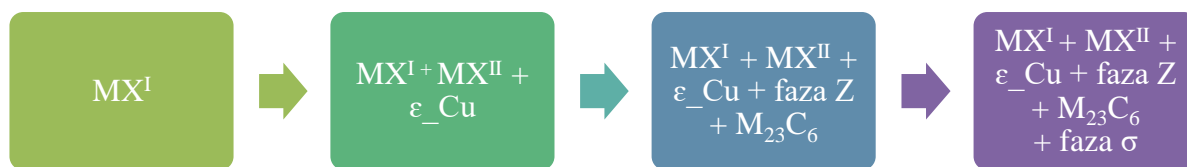
Rys. 95. Sekwencja procesu wydzieleniowego w stali Super 304H
