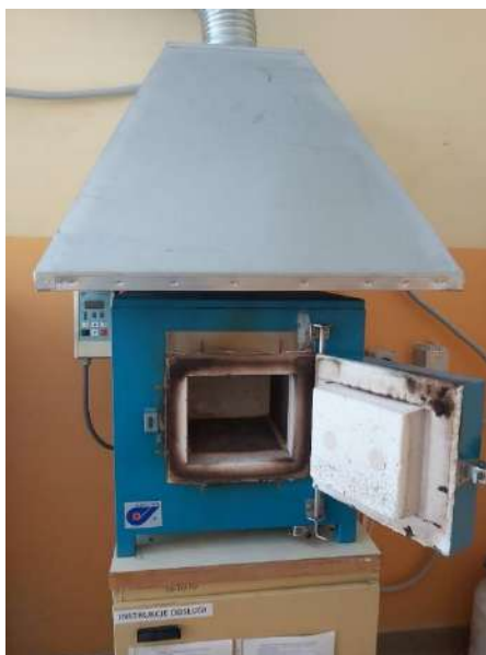
Rys. 32. Piec do prażenia osadów ściekowych [opracowanie własne].
