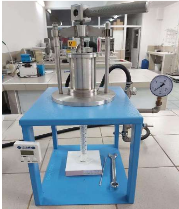
Rys. 27. Stanowisko filtracji ciśnieniowej (cylinder wypełniony osadem ściekowym) [opracowanie własne].
