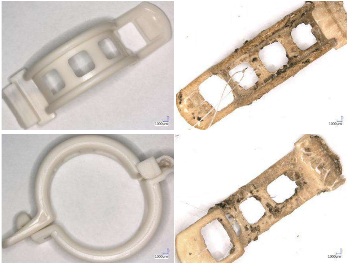
Rysunek 54. Zapinki biodegradowalne CUT1 przed kompostowaniem (po lewej) i po kompostowaniu (po prawej) widoczne w powiększeniu 10x.
