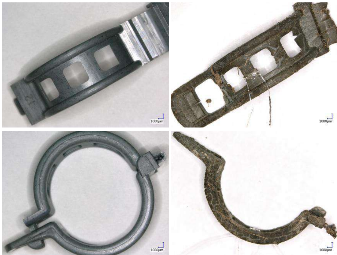
Rysunek 56. Zapinki biodegradowalne CUT2 przed kompostowaniem (po lewej) i po kompostowaniu (po prawej) widoczne w powiększeniu 10x.
