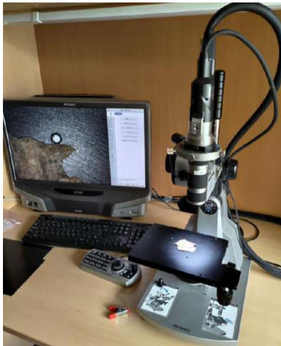
Rysunek 13. Elektroniczny mikroskop optyczny KEYENCE VHX 900 F.
