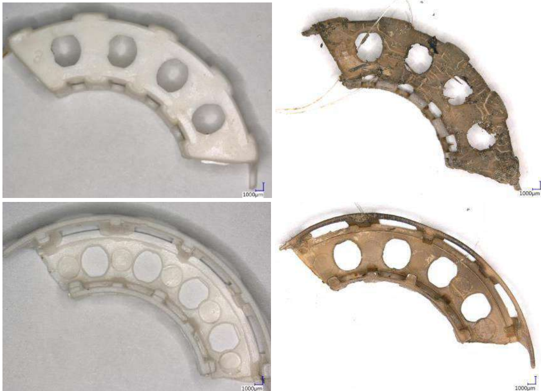
Rysunek 50. Łuki biodegradowalne CUT1 przed kompostowaniem (po lewej) i po kompostowaniu (po prawej) widoczne w powiększeniu 10x.
