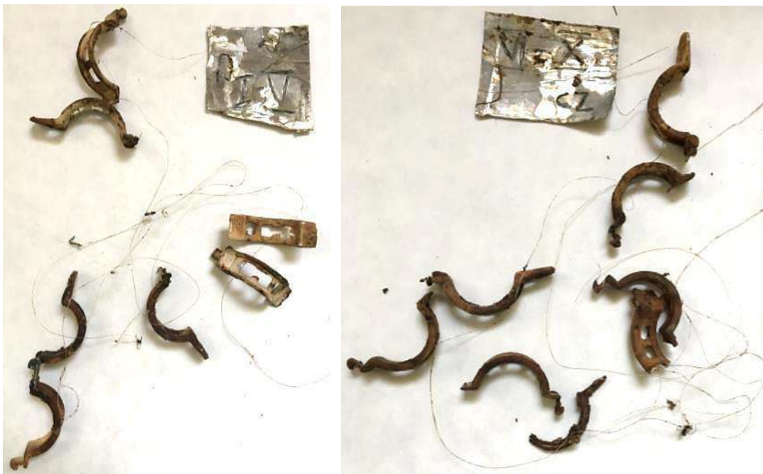
Rysunek 44. Zapinki biodegradowalne CUT1 po zakończeniu kompostowania laboratoryjnego trwającego 116 dni.
