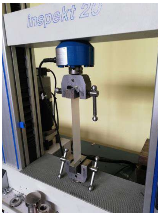
Rysunek 11. Maszyna wytrzymałościowa Inspekt Desk 20 firmy Hegewald und Peshke.
