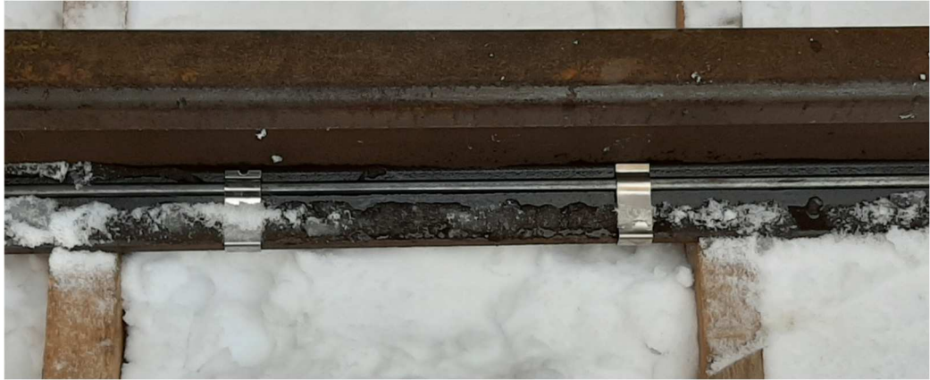
Rys. 5.33. Wytapianie śniegu w układzie EOR po czasie 12 minut. Źródło: opracowanie własne.
