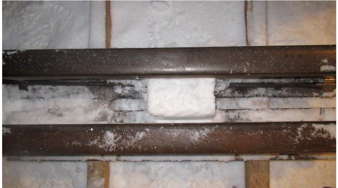
Rys. 5.25. Uformowana warstwa śniegu w formie prostopadłościanu. Źródło: opracowanie własne.
