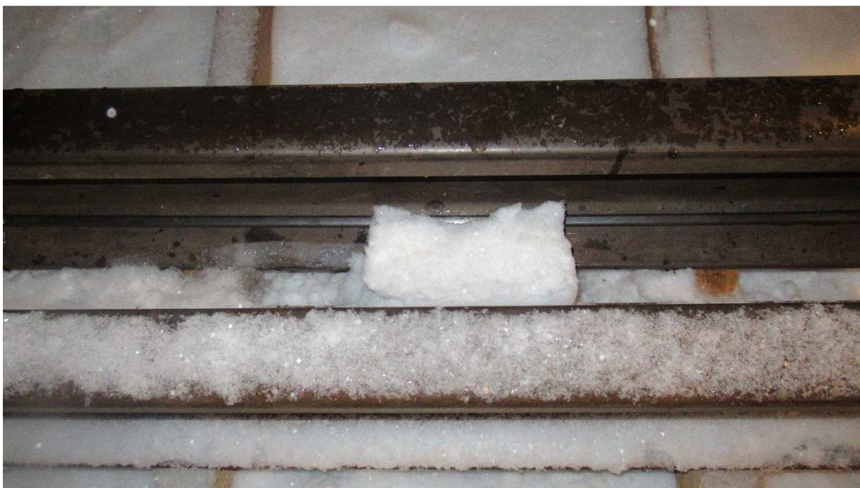
Rys. 5.28. Warstwa śniegu po 43 minutach wytapiania. Źródło: opracowanie własne.
