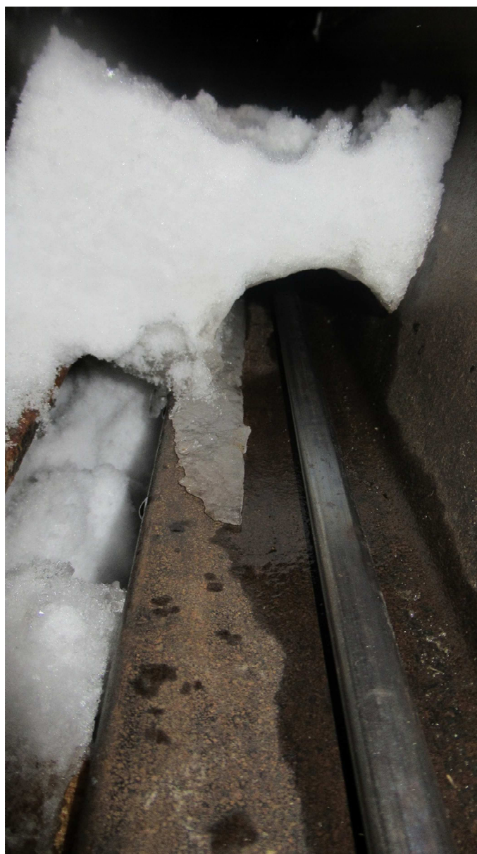
Rys. 5.27. Warstwa śniegu po 28 minutach wytapiania. Źródło: opracowanie własne.
