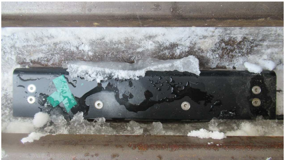
Rys. 5.23. Wytapianie śniegu po czasie 17 minut. Warstwa śniegu w końcowej fazie wytapiania. Źródło: opracowanie własne.
