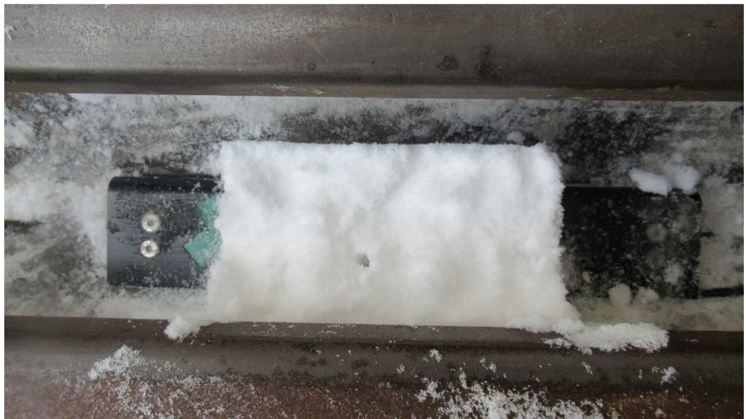
Rys. 5.21. Uformowana warstwa śniegu w formie prostopadłościanu. Źródło: opracowanie własne.
