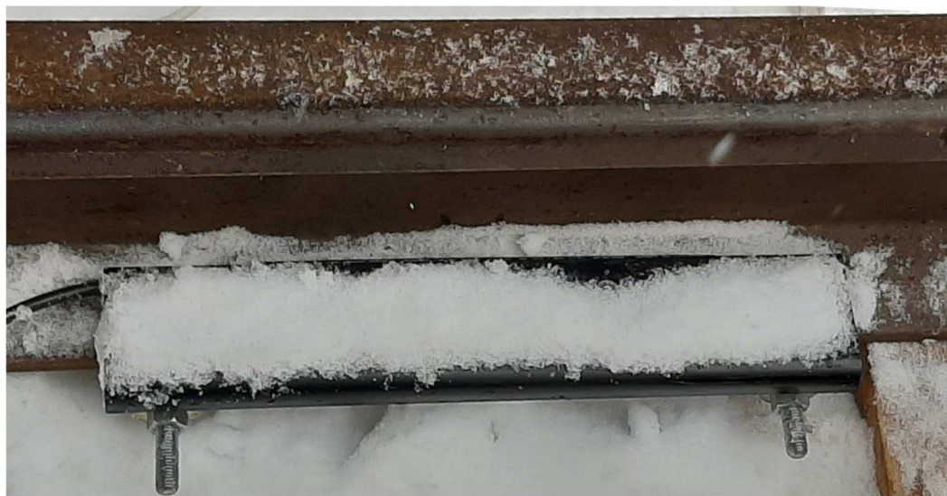
Rys. 5.39. Wytapianie śniegu w układzie IOR po czasie 2 minut. Źródło: opracowanie własne.
