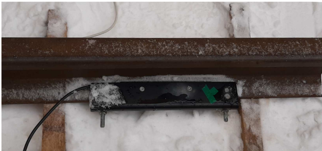
Rys. 5.41. Wytapianie śniegu w układzie IOR po czasie 12 minut. Źródło: opracowanie własne.
