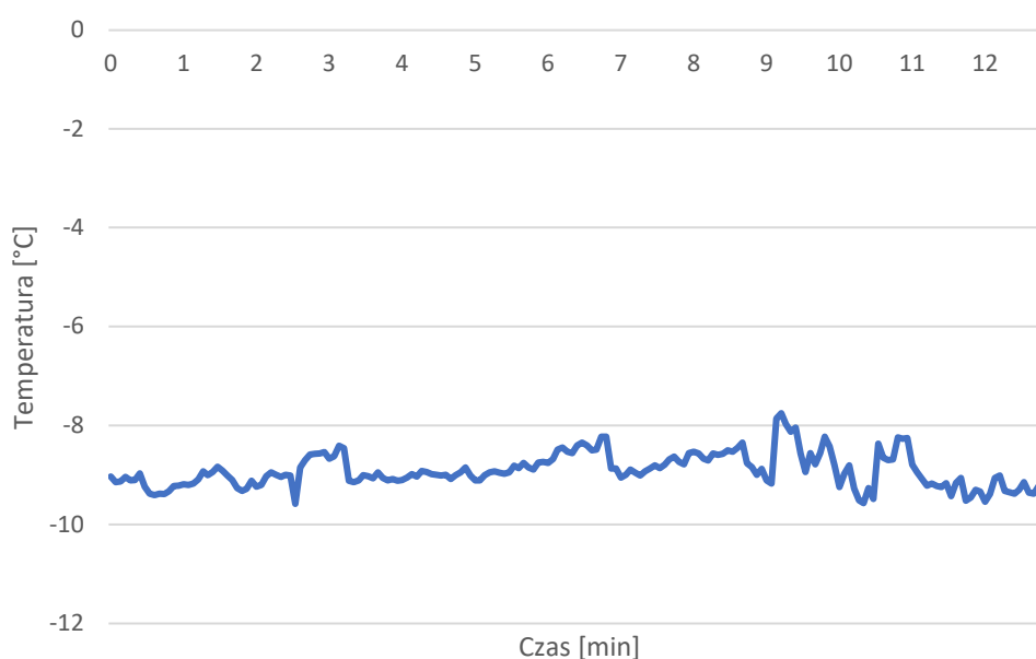
Rys. 5.36. Temperatura główki szyny dla układu EOR. Źródło: opracowanie własne.
