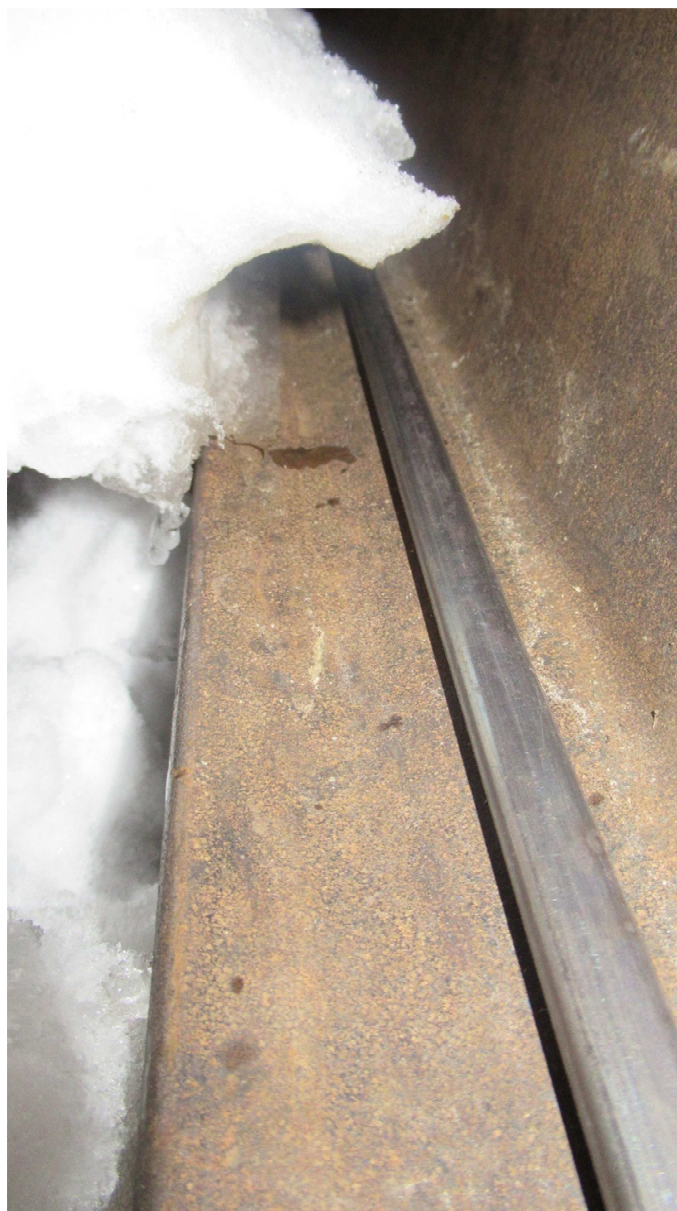
Rys. 5.30. Wytapianie warstwy śniegu w pobliżu ogrzanej i osuszonej szyny po czasie 70 minut. Widoczny nawis śniegu, który jest niewytopiony. Źródło: opracowanie własne.
