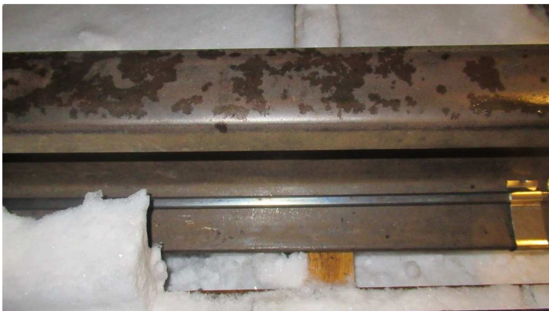
Rys. 5.29. Wytapianie śniegu w pobliżu grzejnika dla układu EOR po 68 minutach. Źródło: opracowanie własne.
