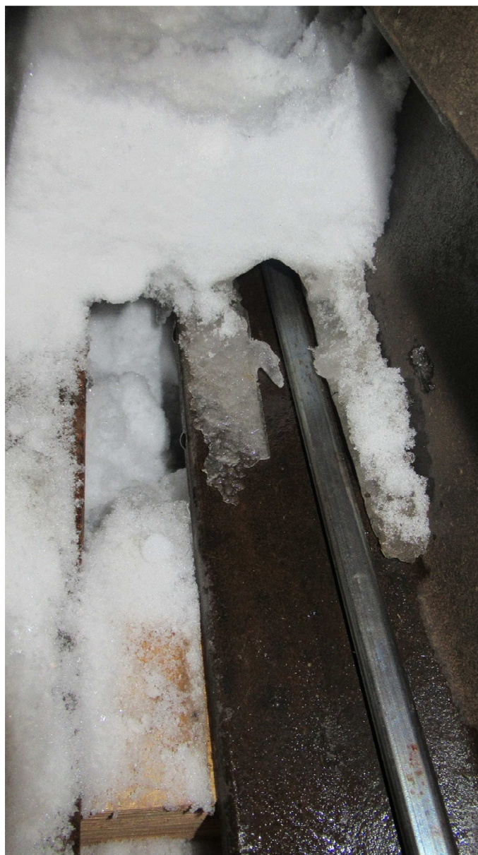
Rys. 5.26. Warstwa śniegu po 12 minutach wytapiania. Źródło: opracowanie własne.
