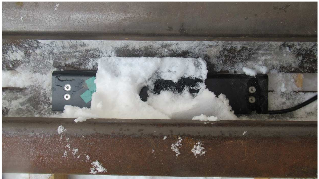
Rys. 5.22. Wytapiana warstwa śniegu po czasie 12 minut. Źródło: opracowanie własne.
