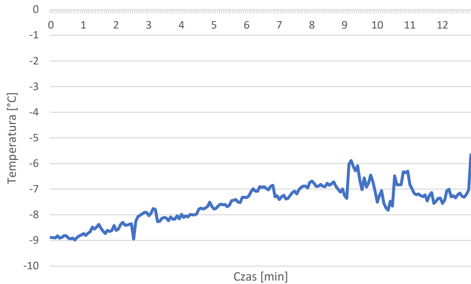
Rys. 5.37. Temperatura szyjki szyny dla układu EOR. Źródło: opracowanie własne.
