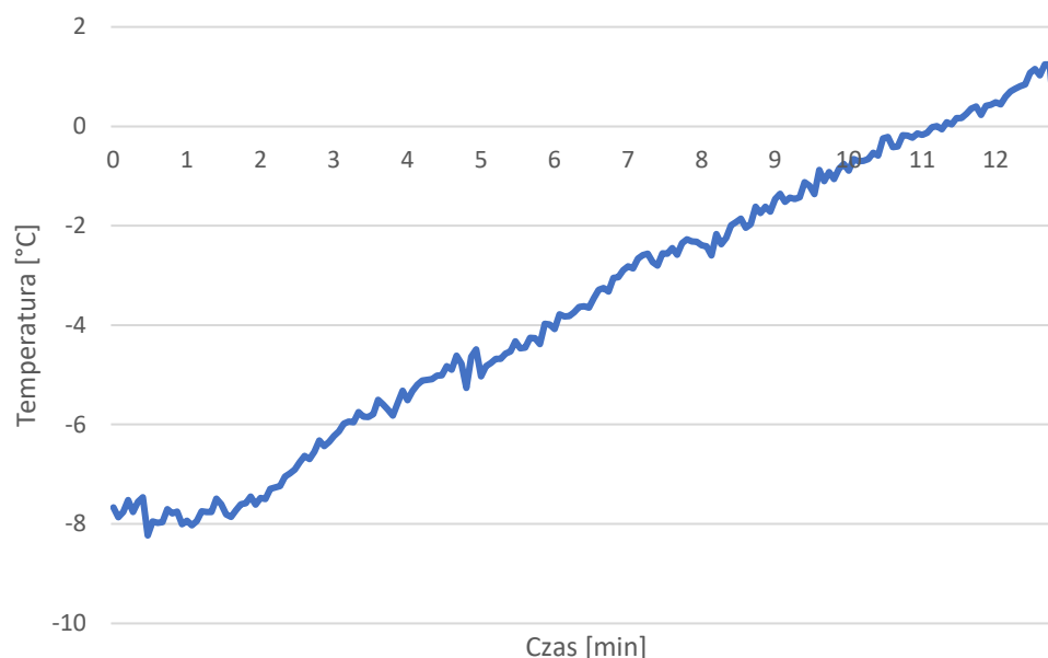
Rys. 5.45. Temperatura szyjki szyny dla układu IOR. Źródło: opracowanie własne.
