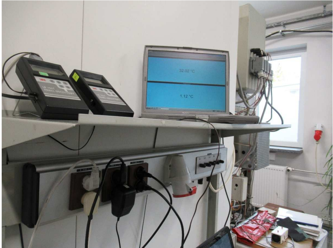
Rys. 5.2. Opomiarowanie urządzenia IOR w trakcie badań w komorze klimatycznej. Źródło: opracowanie własne.
