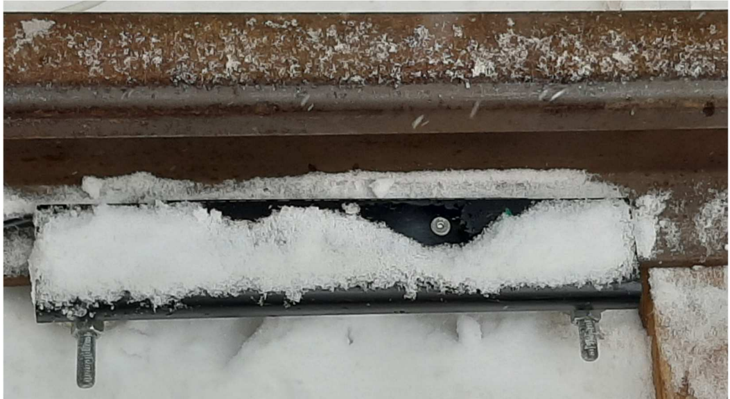
Rys. 5.40. Wytapianie śniegu w układzie IOR po czasie 5 minut. Źródło: opracowanie własne.
